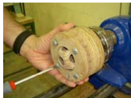
La boule est pratiquement terminée tenue dans son support « spécial Misiak »
