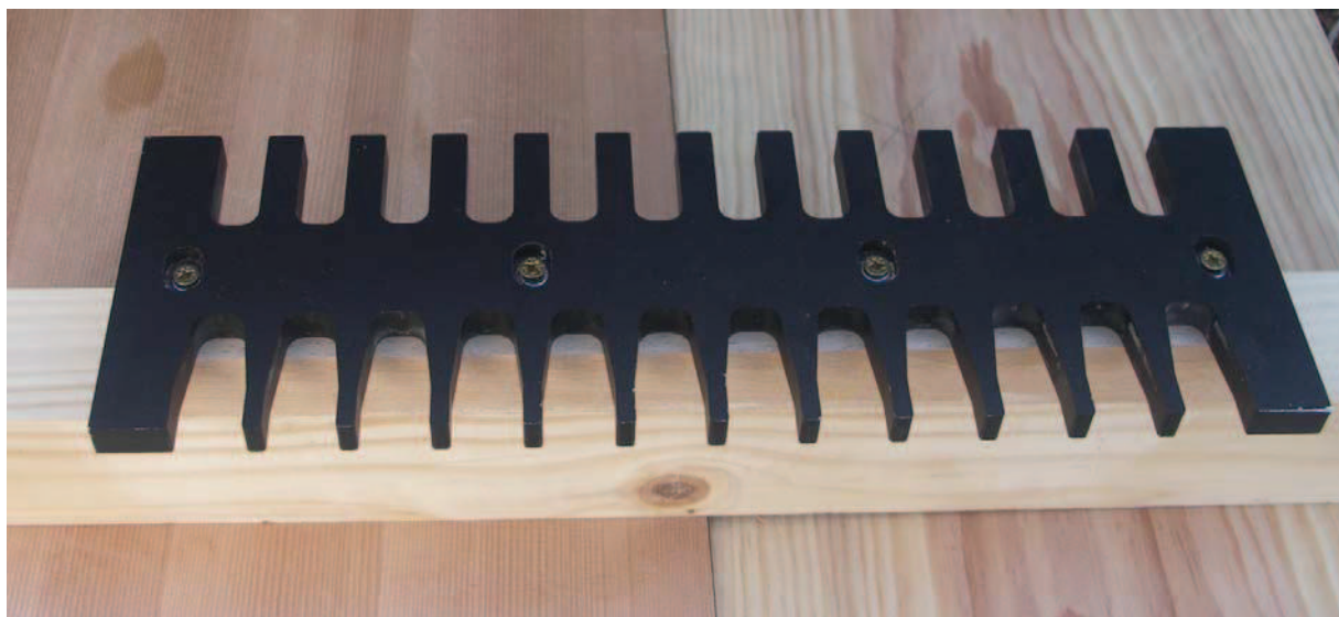
Figure 7 Le peigne monté sur son support
