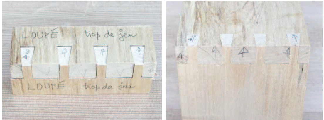
Figure 8 A gauche, trop de jeu ; à droite jeu correct
