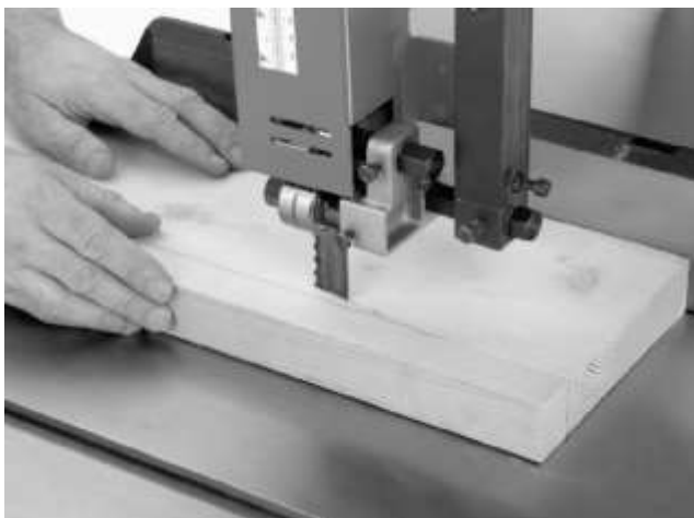
Figure 11 Exemple de déviation naturelle de la coupe et réglage du guide
