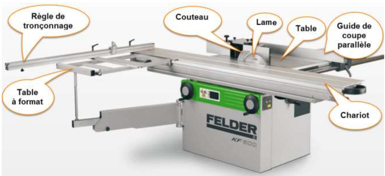
Figure 1 Les organes de la scie circulaire
