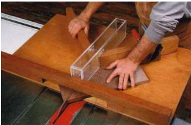
Figure 7 Le guide à coupe d'onglet et le guide à queues droites
