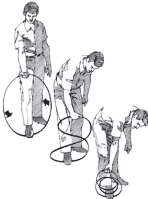
Figure 12 Pliage d'une lame en 3 boucles
